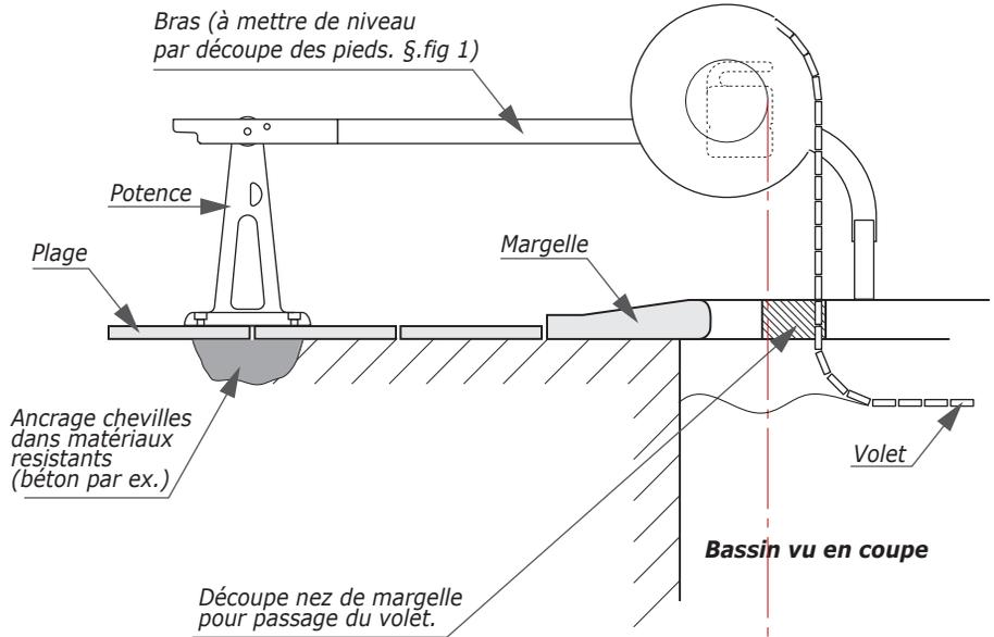
Bord du tube d'enroulement à l'aplomb du départ de l'arrondi
